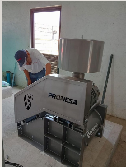
15 de marzo de 2024, suministro e instalación de soplador lobular de 25HP, MOD. 5MS
